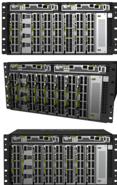
図2. ジュニパーACX7509 : Juniper Cloud Metro の IP サービスファブリック向けに設計
